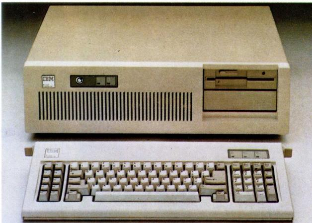
Questo è il modello di punta della generazione PC prodotta dall'IBM. Per l'IBM AT viene fornita una nuova tastiera che si distacca dalla precedente produzione.
