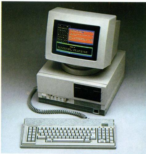
*Il personal M24-3270 combina le funzioni interattive del sistema IBM 3270 con la versatilità e la potenza che contraddistinguono i personal computer Olivetti.*
