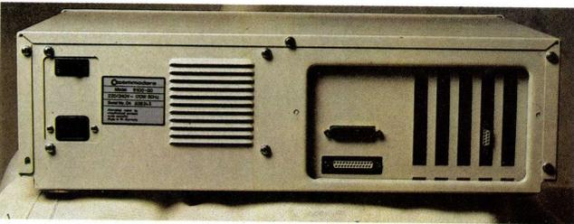
*Retro del Commodore PC 10. Si notino i 5 slot per le espansioni di cui 1 occupato dall'adattatore per il monitor e le due porte, una parallela e una seriale.*
