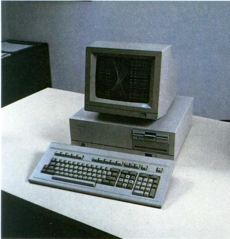
*In questa illustrazione è visibile il monitor che abbiamo ricevuto in prova, capace di una risoluzione di 640 x 400 punti in 256 tonalità di colore.*
