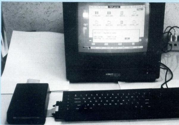
Il QL al lavoro con l'interfaccia dischi e il floppy disk drive singolo della Sandy. Sul monitor è visualizzato l'interessante programma ICE che lavora interamente ad icone.
